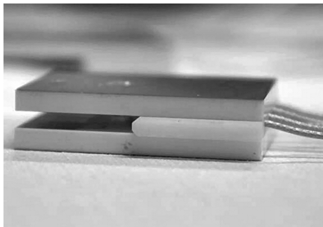
Afbeelding 9. De capacitieve sensor.
