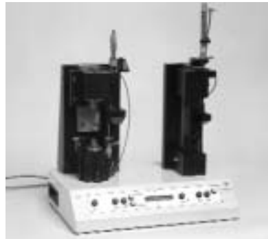
Afbeelding 6. Het hulpgereedschap Ultra Block, dat bestaat uit twee units die button en opspanpen nauwkeurig op elkaar uitlijnen met reproduceerbare waslaagdikte.
