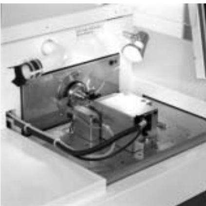
Afbeelding 3. De X-slede gemonteerd vóór de kop van de hoofdspil. Op de slede links twee meettasters, in het midden de Fastool met drie periodiek bewegende beitels en rechts twee vast op de slede gemonteerde beitels.
