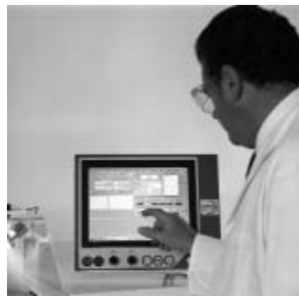
Afbeelding 4. Het bedienen van de Diatop via het aanraakscherm dat communiceert met de PCNC-besturingssoftware.
