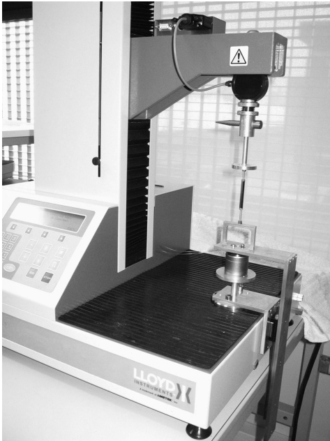
Afbeelding 5. Trekbank voor het testen van VCA's op kracht.
