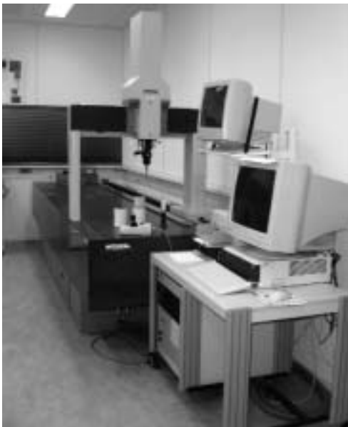
Afbeelding 1. Een meetmachine Wenzel LH64 CNC voor het automatisch kalibreren van linialen, reien en rolmaten.
