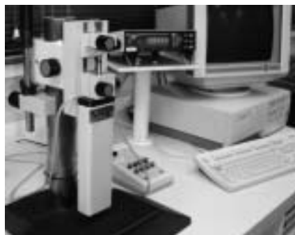
Afbeelding 6. Een meetklokkentester van Helios met een resolutie van 100 nm.
