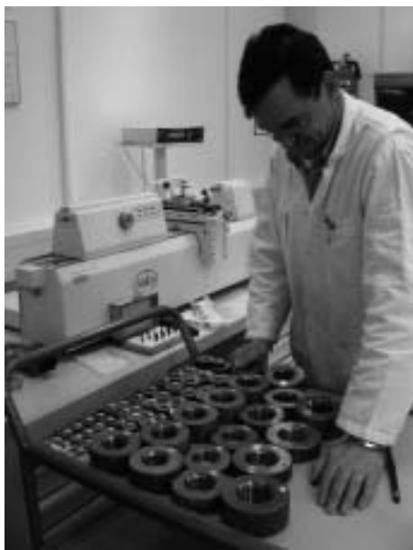
Afbeelding 4. Controle van schroefdraadkalibers met een Helios lengtemeetmachine.
