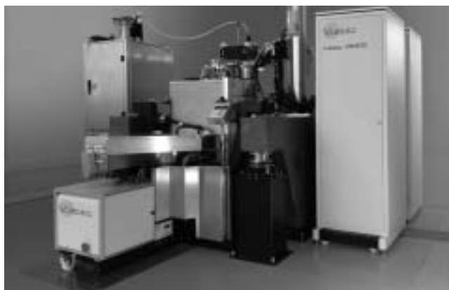
Afbeelding 9. Een EBPG-systeem, de Vistec VB300.
