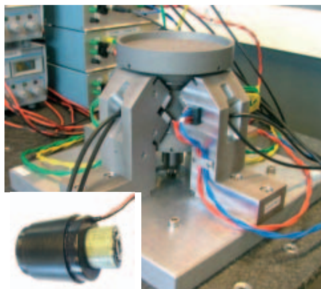
Figuur 8. Experimentele opstelling van de rotor voor een 'optical disk mastering device' en de permanente-magneetmotor (de inzet) die de rotor moet aandrijven.
