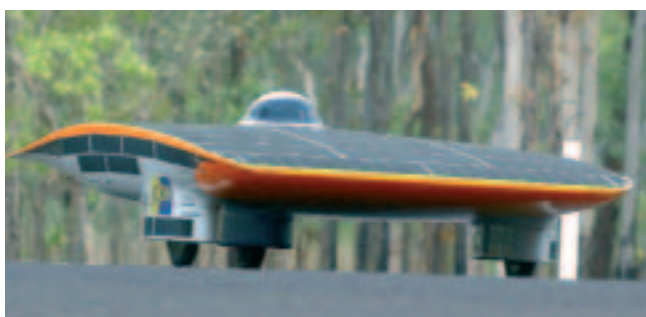
Figuur 9. De Nuna, een auto op zonne-energie, is uitgerust met een permanente-magneetmotor.
