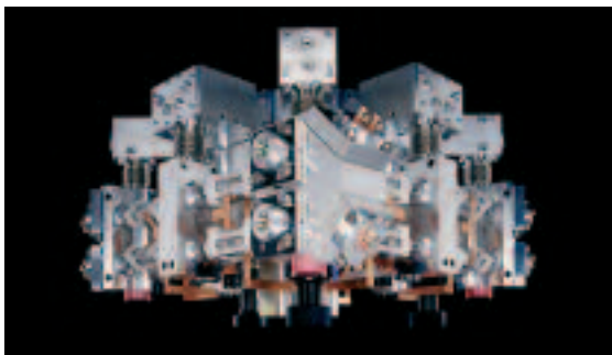
Afbeelding 2. Met een bundelverdeelstelsel kan één laser op meerdere plaatsen worden ingezet.
