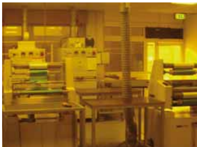
Afbeelding 2. De 'gele doka' van Etchform: geel licht beïnvloedt UV-gevoelige lak niet. Op de voorgrond apparaten voor het opbrengen van zogeheten droge lak, een soort folie. Op de achtergrond een apparaat voor gefocusseerde belichting.
