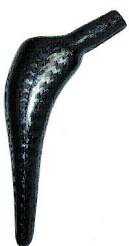
Afbeelding 7. Een dijgewricht-implantaat met zacht matrixmateriaal voor de complexe vorm en met vezelwapening voor de benodigde stijfheid en sterkte (prof. Zako, Osaka University, Japan).
