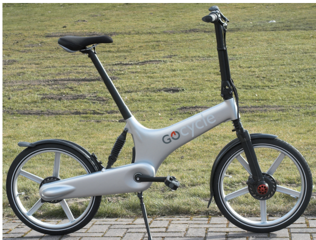
Afbeelding 12. De GOCycle is een geavanceerde stadsfiets die dankzij Thixomolding in grote aantallen tegen relatief lage prijs kan worden geproduceerd.
