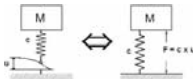
Afbeelding 4. Dynamische equivalentie van piëzo als positie- danwel als krachtactuator
