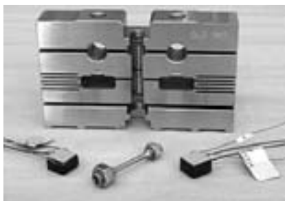
Afbeelding 3. Voorspanconstructie voor Smart Disc prototype van de Universiteit Twente
