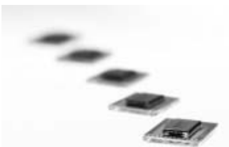
Afbeelding 3. Geassembleerde FMCM sensor op een test substraat. Combinatie van vloeistof stroming met elektrische aansluitingen
