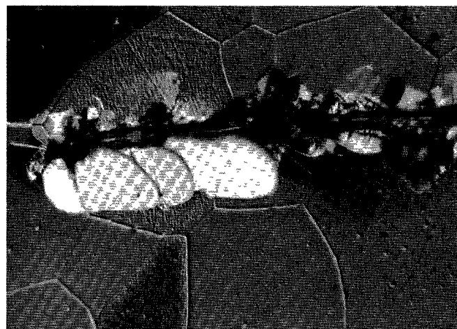
Foto 9. NiZn ferriet na een kras onder een belasting van 0,5 N. Het oppervlak vertoont scheuren in de korrels en schollen door de korrelgrenzen heen (zie links boven, vlak bij het begin). De drie witte schollen aan de onderzijde zijn opgewipt nadat de diamantpyramide gepasseerd was.
