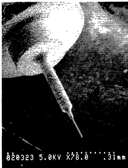
Figuur 9a Hardmetalen, gevonkte elektrode van \varnothing 10 \mu m en 150 \mu m lengte. De (micro-)vonkstructuur is nog duidelijk te herkennen.
