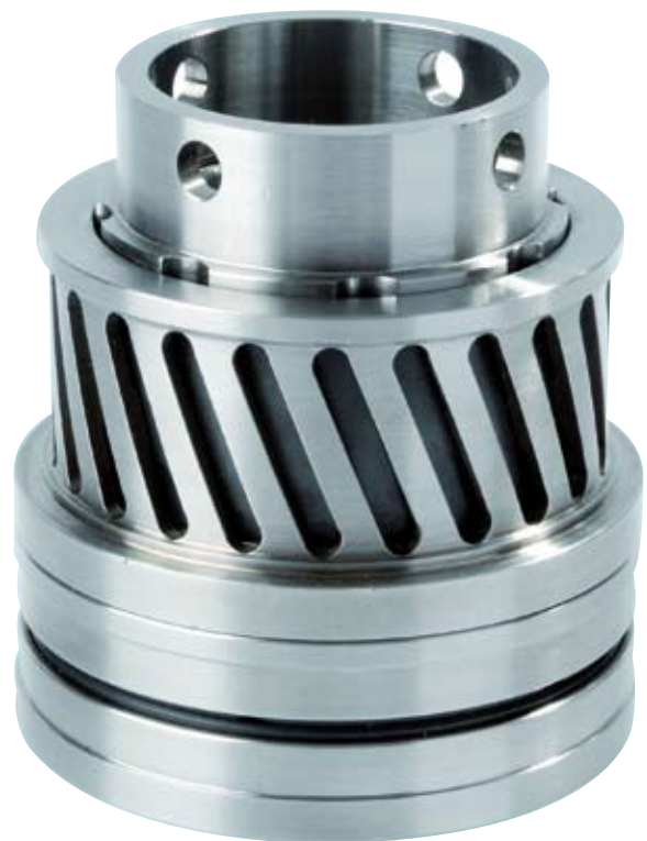
Afbeelding 8. Glijlagerconstructie met nauwkeurig in elkaar passende loopvlakken van SiC, bedoeld voor toepassing in magneetgekoppelde pompen.
