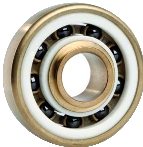
Afbeelding 5. Een kogellager met ringen van ZrO_2 en kogels van Si_3N_4 , voorgespannen door middel van een ring van RVS 316.
