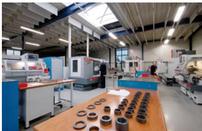
Afbeelding 1. Het moderne machinepark van Ceratec Technical Ceramics omvat een arsenaal aan CNC-slijpmachines; rechts een vier-assige uitvoering.
