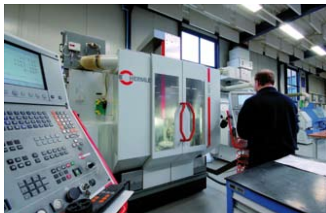
Afbeelding 1. Het moderne machinepark van Ceratec Technical Ceramics omvat een arsenaal aan CNC-slijpmachines; rechts een vier-assige uitvoering.
