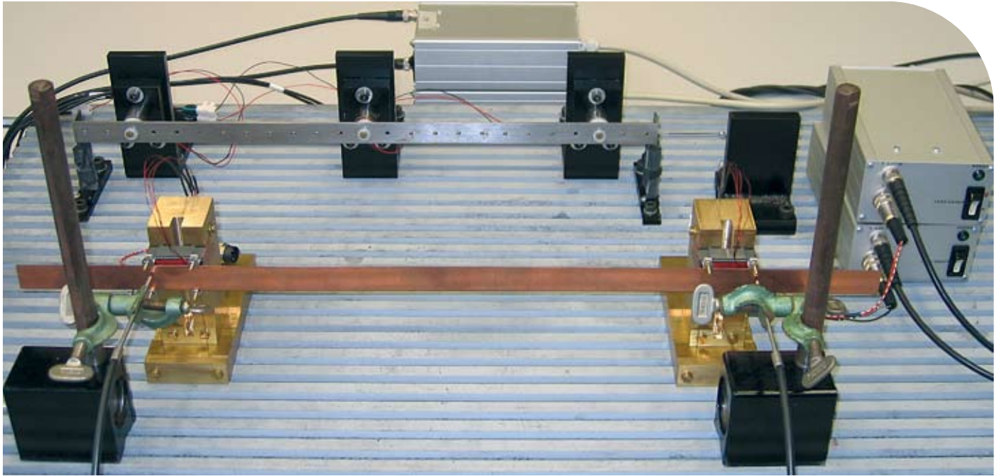
Positioneringstelsel met beweging in één richting, ondersteund door twee actuatoren die twee graden van vrijheid combineren
