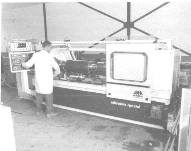
Figuur 8 Mikroturn CNC voor het precisiebewerken van walsrollen.
