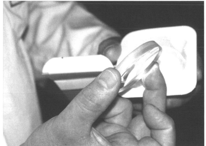
Afbeelding 4. Een zogenaamde blank, die bij Essilor Nederland volgens recept wordt bewerkt tot brillenglas
