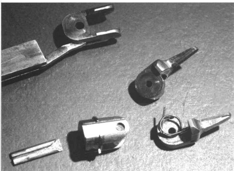
Afbeelding 15. De onderdeeljes van een grijper.
