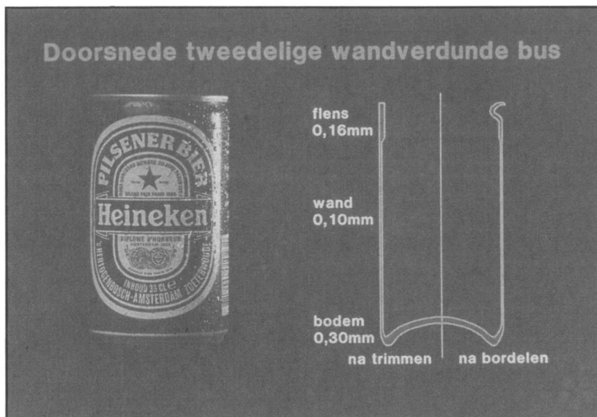
Figuur 4 Doorsnede tweedelige wandverdunde bus.
