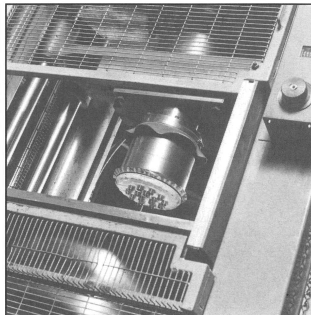
Neodure-poeder wordt onder invloed van een magnetisch veld in de gewenste vorm geperst, waardoor de domeinen een magnetische voorkeursrichting krijgen (foto: Philips).
