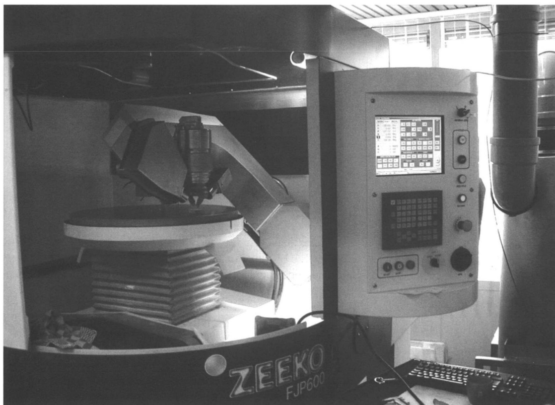
Afbeelding 2: Overzicht van de ZEEKO FJP 600. Zichtbaar zijn de interferometer, de FJP spuitkop en de bedieningszuil.
