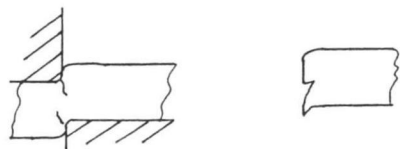
Figuur 11 Extrusiebraam bij te kleine snijspleet.
