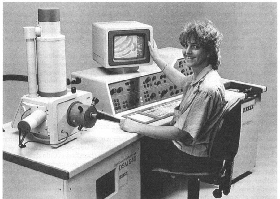
Een van de diverse types elektronenmicroscopen van de fa. Zeiss. In dit geval een raster-elektronenmicroscop. Zeiss heeft ook transmissie-elektronenmicroscopen. Qua uiterlijk verschillen die niet veel.
