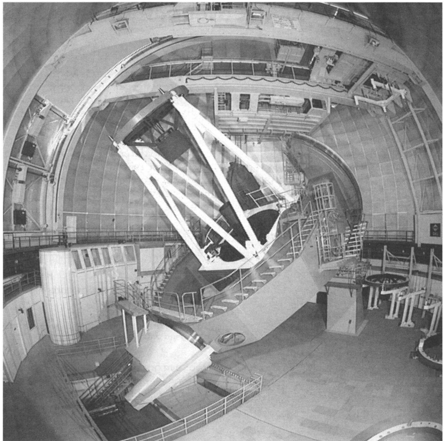
De 3,5 m spiegeltelescoop van de sterrenwacht van Calar Alto. Het is een van de grootste kijkers van Europa en hoort ook bij de grootste ter wereld. Een paar getallen: totaal gewicht: 430 ton, beweegbaar 230 ton. Positie/nauwkeurigheid aan de hemel: 0,1 bgsec. Spiegels: asferisch, met een vormnauwkeurigheid \pm 0,000.015 mm.
