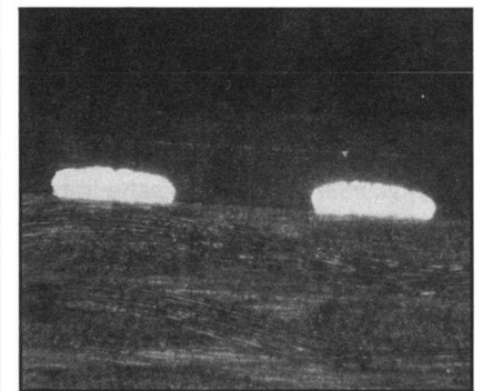
Figuur 2a Doorsnede van opgesmolten soldeer op koperspoor.
