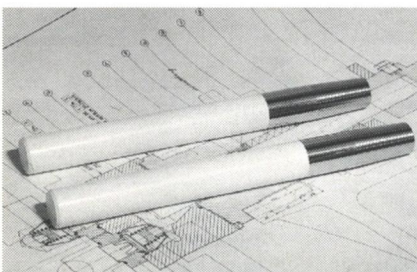
Figuur 2. Plunjer van aluminiumoxyde, verlijmd aan een roestvaststaal as. De plunjer is gemaakt voor een homogenisator voor het verwerken van ongezouten wei.
