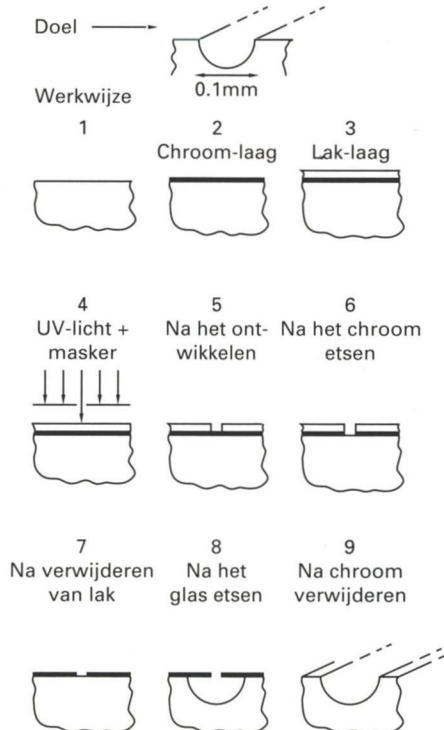
Figuur 1. Het fotolithografische proces zoals dat wordt toegepast om een groef in een glassubstraat te etsen.
